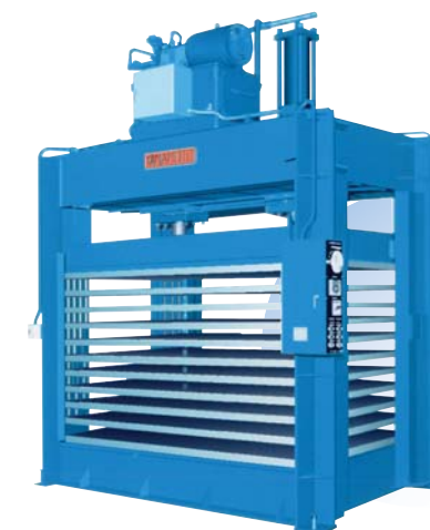
ウレタン発泡パネルプレス(車体パネルの製造)
