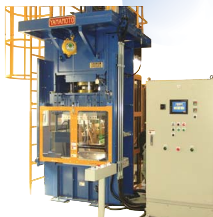
実験用プレス(各種加熱圧縮の実験)
