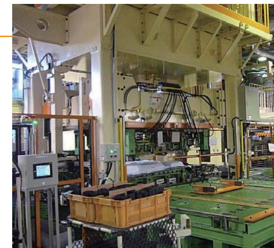
トリムプレス(フェルトやゴムシート類型抜き)
